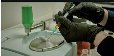
A través de este equipo se realizan análisis de calidad de materia prima por comparación con compuestos de referencia preestablecidos. Además, permite identificar grupos funcionales en un amplio intervalo del espectro.
