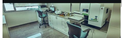
El espectrofotómetro de emisión atómica permite obtener resultados de multielementos en una corrida, de una manera rápida y práctica.
